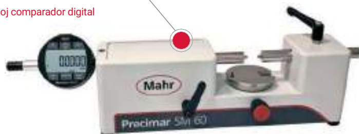
MarCator 1086 Ri con banco de medición de longitudes
